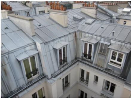
Toiture à la Mansart en zinc : le zinc réfléchit les rayons du soleil en journée ce qui est un avantage pour le microclimat urbain, mais sa faible inertie rend les logements sous toitures assez inconfortables.
