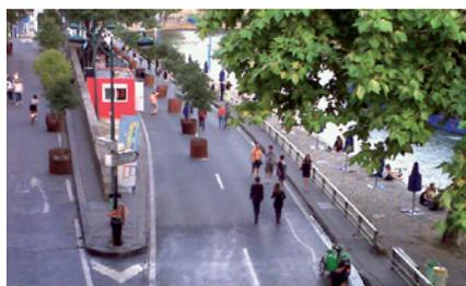
Port des Célestins le 31 juillet 2011 à 21h30 : effet de refroidissement après aspersion de la chaussée. La température de la chaussée chute d'une dizaine de degrés.
