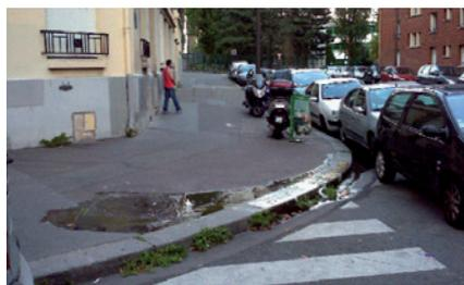
Porte de Bagnolet le 25 juillet 2012 à 21h30 : effet de refroidissement induit par l'écoulement d'une bouche de lavage (refroidissement dû à l'écoulement et à l'évaporation). La zone arrosée est 12 °C plus fraîche que le restant du trottoir.
