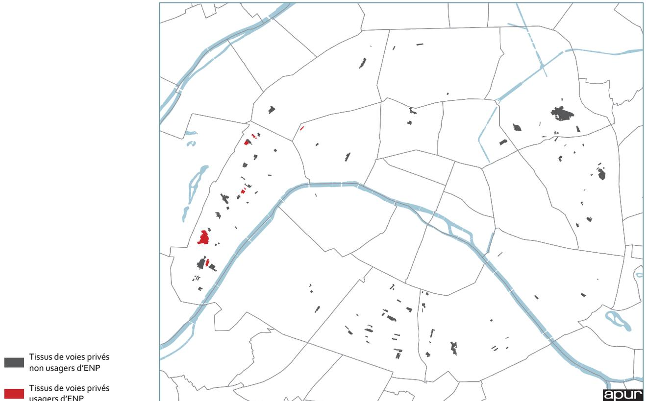
La localisation de l'ensemble des tissus de voies privées permet de montrer le potentiel de raccordement au réseau ENP. Sur l'ensemble, soit 219, uniquement 6, dont 5 situés dans le 16<sup>e</sup> arrondissement, sont connectés.
