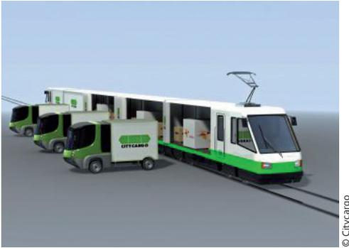
Une flotte de 600 véhicules électriques, les E-cars, permet d'assurer la livraison finale. La capacité d'une E-car est de 2 t pour 200 km d'autonomie. La largeur est de 2,1 m (largeur du conteneur). Son coût est de 44 k€.
