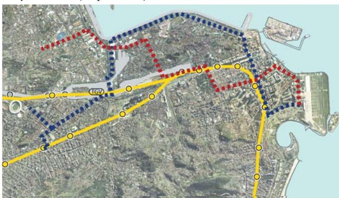
Phase 2 (2018) : extension et reconfiguration du réseau en 2 lignes de tramway de 10 et 8 km
