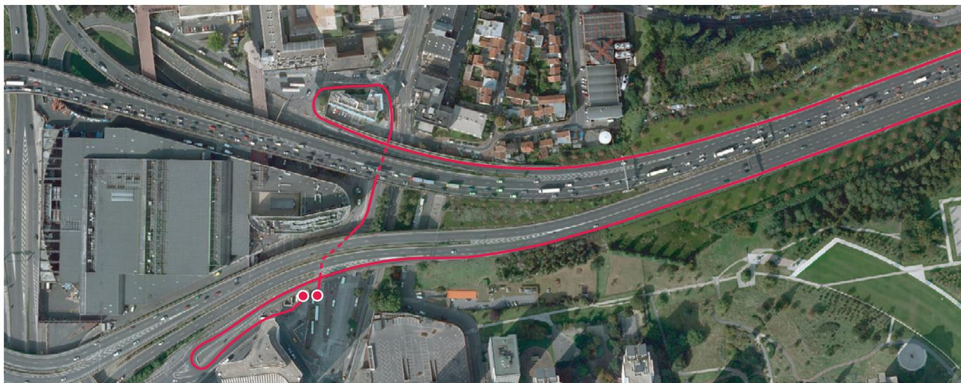
Principe d'implantation d'un BHNS sur la BAU de l'A3 à hauteur de l'échangeur de Bagnolet et du pôle Gallieni
