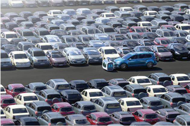
Le robot plateforme Stan récupère et dépose les voitures laissées par leur propriétaire dans des boxes prévus à cet effet.
