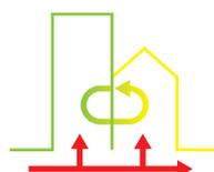
Une alimentation double pour le tissu d'habitat collectif et mixte avec un recours aux réseaux traditionnels associé à l'apparition de boucles locales d'énergie valorisant les ressources locales (énergies fatales, solaire, géothermie, mutualisation énergétique, etc.).
