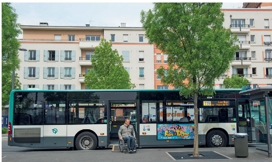
L'accessibilité des bus aux utilisateurs de fauteuils roulants facilitée par une rampe escamotable intégrée au bus.
