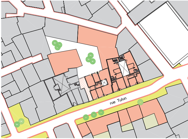
مشروع تطوير شارع طولون مشروع تفصيلي لقطع الأراضي من نمرة ٤٢ إلى ٤٨ مباني مقترح إنشائها مباني قائمة Rue Tûlûn : projet Projet détaillé pour les parcelles n° 42 à 48 Bâtiments projetés Bâtiments existants
