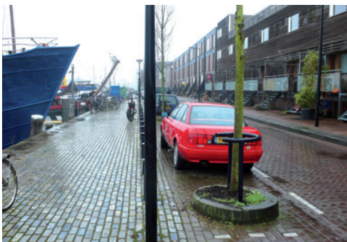
Amsterdam : quartier de Borneo, revêtement des quais avec des briques vernissées de réemploi
