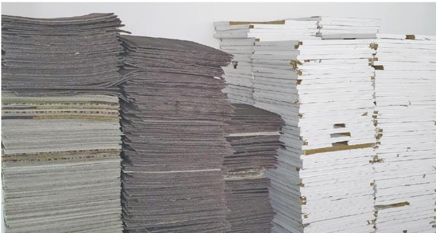
Réemploi de dalles moquette
