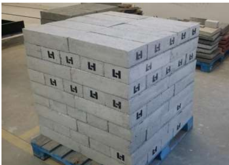
Fig 3 : Blocs de béton incorporant 50% de polystyrène recyclé
