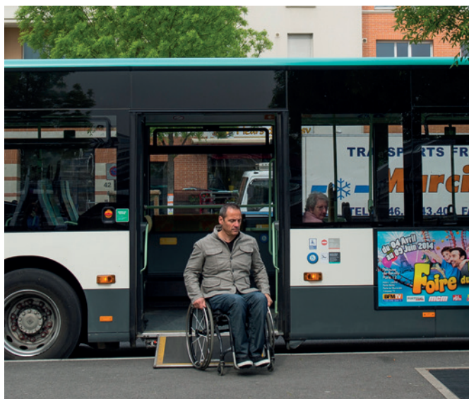
Bus équipé d'une palette rétractable, facilitant l'accès aux PMR, et notamment aux usagers en fauteuil roulant
