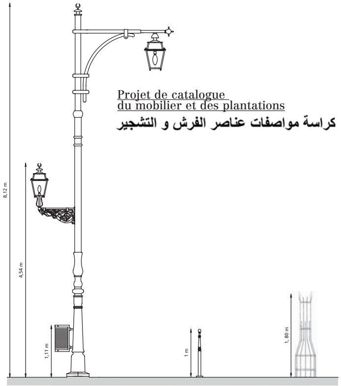
وحدات إضاءة على أعمدة معدنية بارتفاع ٦,٥ متر Candélabre sur fut métallique Hauteur : 6,50 m
